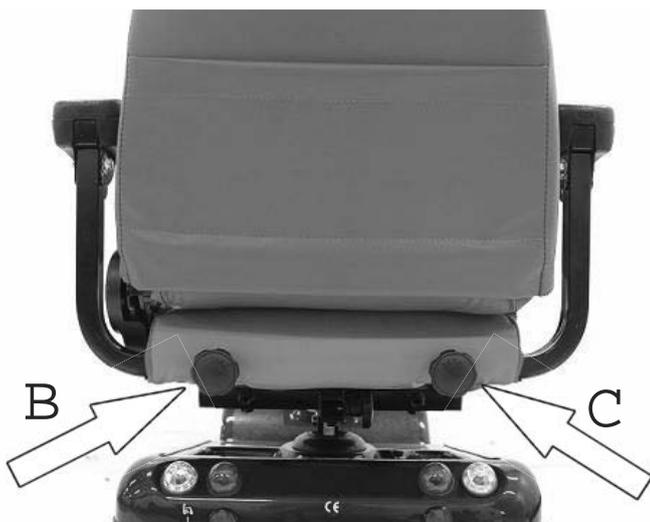
Armlehnenbreite Einstellen: Sie können den Abstand der Armlehnen einstellen. Dazu finden Sie am hinteren Teil des Sitzes links und rechts große schwarze Drehschrauben (Pfeile B u. C). Durch einfaches Lösen dieser Drehschrauben können die Armlehnen nach innen oder nach außen verschoben werden. Nach dem Einstellen ziehen Sie die Schrauben wieder fest an. Eventuell benötigen Sie Hilfe bei der Einstellung während Sie auf dem Elektromobil sitzen.
